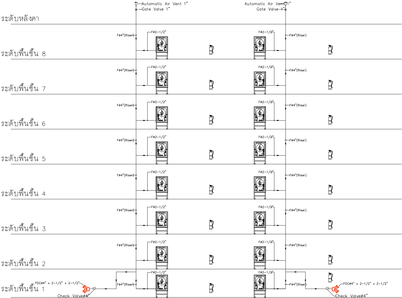
ไดอะแกรมระบบดับเพลิง อาคาร B มาตราส่วน NTS.
